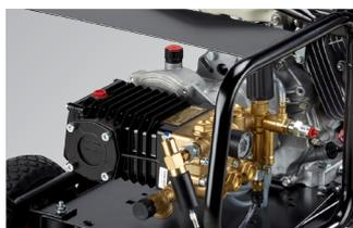
Nouvelle pompe CL 6.0 auto-amorçante à trois pistons en « FULL » céramique, double visière à huile et tête en laiton. Réducteur de régime entre le moteur et la pompe. Nouvelle vanne de régulation de pression à bride L3.1
